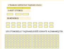
Şekil 22: Tramvay/Otobüs/Minibüs/Otomobil Kapasitelerinin Karşılaştırılması
