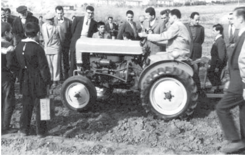
Traktör bir gövdeli pulluk çekebilecek şekilde tasarlanmıştır.
