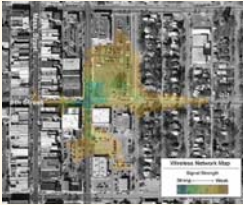
Şekil 18b: Erişim noktalarının güçlerini gösteren hava fotoğrafı
