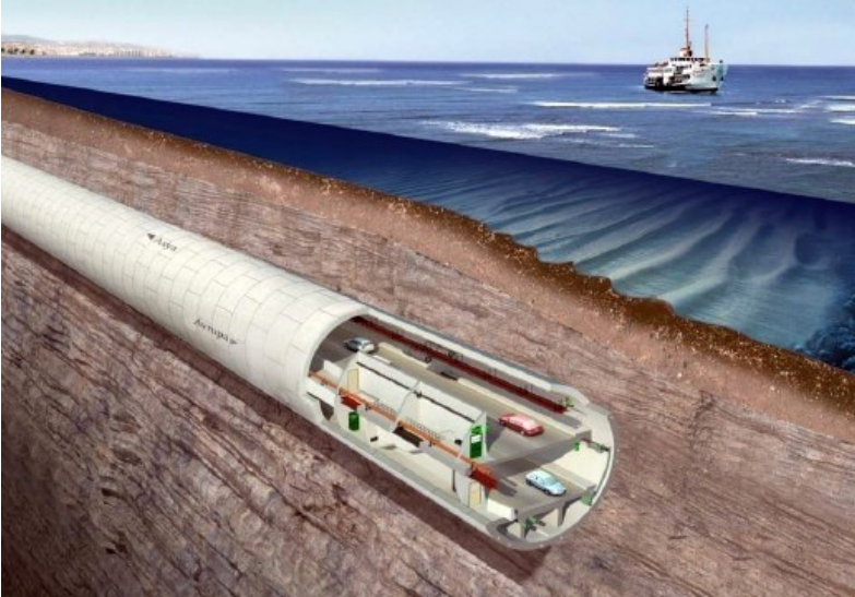
Şekil 3. Projenin denizin altından geçecek olan ana tünel kesiti
