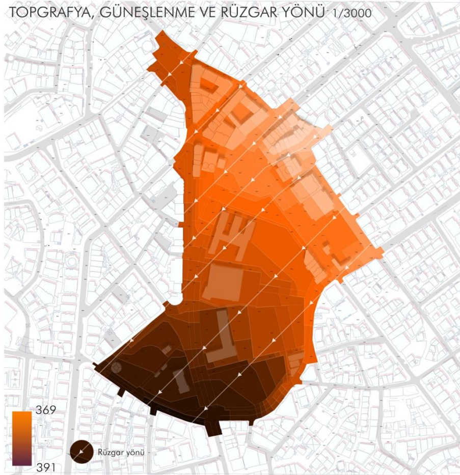
Şekil 4.5 Eğim, Rüzgar Yönü ve Güneşlenme Durumu
