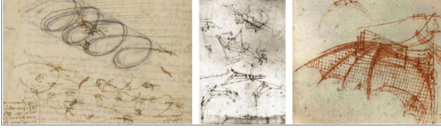
Şekil 1. Leonardo Da Vinci'nin Kanat Mekanizması Tasarımı Çizimleri – solda kuşların hareketini gözlemlediği soyut karalamalar, ortada detaylandırılmış mekanizma çizimleri, sağda kanat tasarımının son hali
