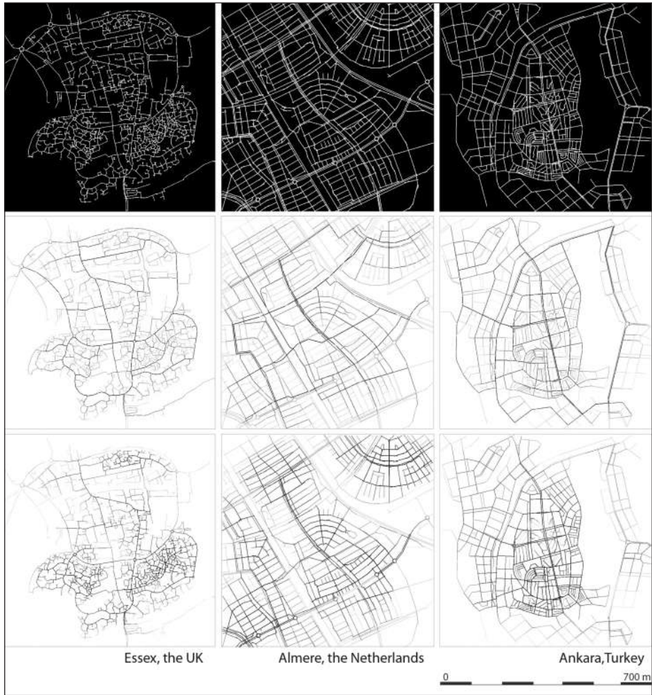
Şekil 10. Essex (İngiltere), Almere (Hollanda) ve Ankara (Türkiye)'deki planlı konut alanlarından tipik yol dokusu örnekleri (üst), yol ağındaki araç akışı potansiyelini gösterir 'geniş çaplı seçim örüntüleri' – global choice pattern - (orta) ve yaya potansiyelini gösterir 'yerel bütünleşiklik' (entegrasyon) örüntüleri (alt).
